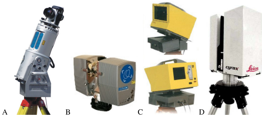
Kuva 5. Vertailtavat laserkeilaimet. A: Riegl LSM-Z420i, B: FARO880HE80, C: Optech ILRIS-36D ja D: Leica HDS4500.
