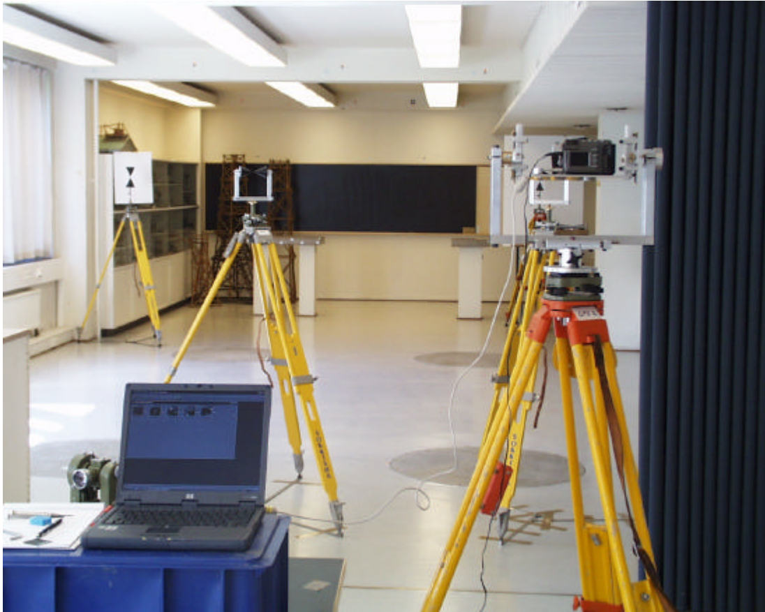
Kuva 9. Kuvaujärjestely. Kameran laukaiseminen sekä kuvien analysointi suoritettiin kameraan kytketyllä tietokoneella.
